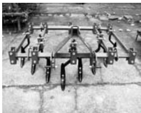
Ovaj vinogradarski kultivator opremljen je sa tri vrste plužnih tijela i to: desna, lijeva i srednja plužna tijela
