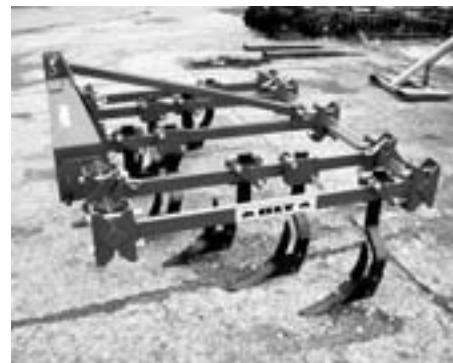
Ovim kultivatorom tlo se intezivnije rahli, sitni, mješa ali što je najvažnije uništava se korov
