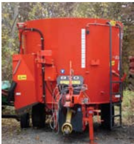
Vertikalna mikserica s prednje strane. Vidljiv kardanski način priključka i ljestve za nadzor miješanja
