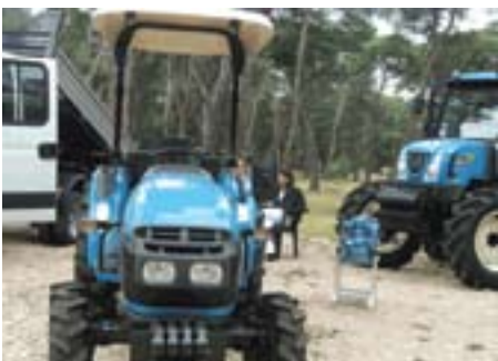
LS traktor ima vrhunski Mitsubishi motor s 4 cilindra
