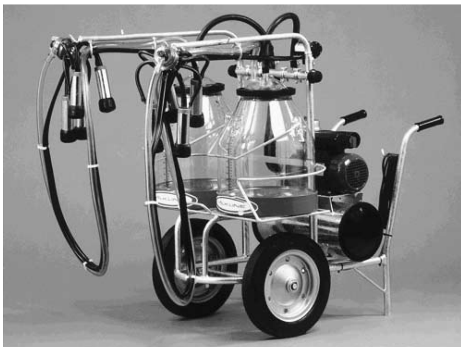
Muzni uređaj s dvije kante i dvije muzne jedinice
