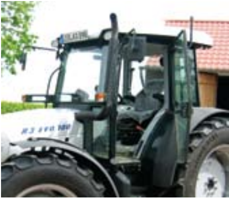
R3 EVO s ergonomskom kabinom s četiri mostnice za optimalni pogled
