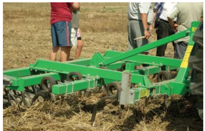
Sterncracker je višenamjenski frontalni stroj koji se može upotrijebiti kao priključno oruđe, odnosno kao sjetvospremač, a ona našoj slici je verzija XXL koji služi za reduciranu obradu tla bez pluga.
