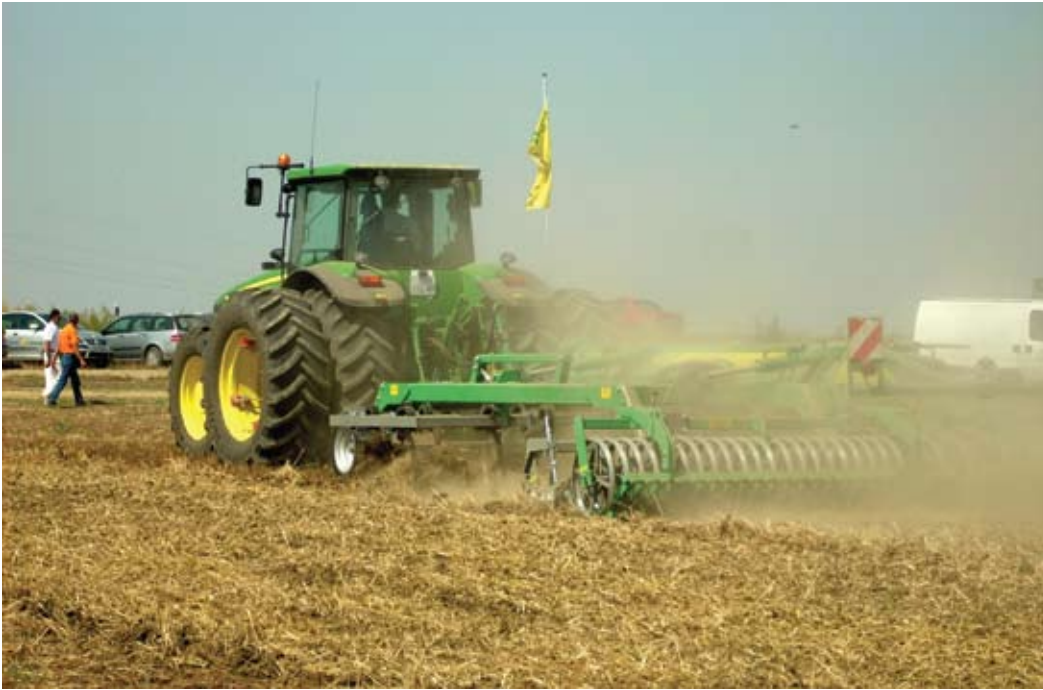
Vibroliner je polunoseće oruđe za univerzalnu uporabu, kako obradu strništa, tako i pripremu sjetve bez uporabe pluga. Učinak je barem kao kod rada s drljačom, ali s dvostruko većim zahvatom
