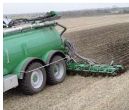
ubacivanje gnojnice – dva radna zahvata kombinirana u jedan: obrada tla i istovremeno gnojenje
