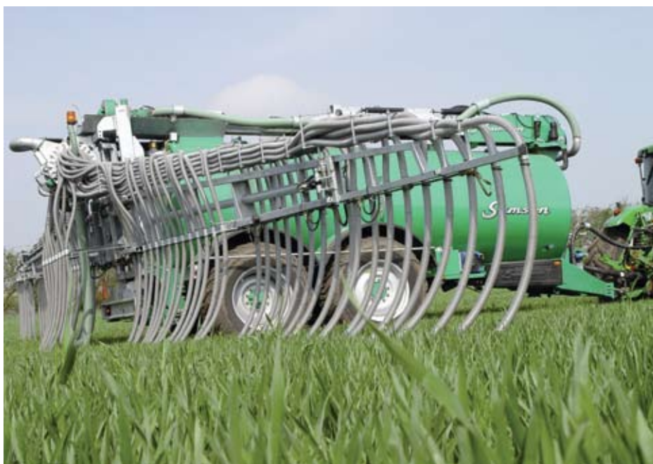
Slika 2 – vučeni raspršivač gnojnice: za rasprostranjivanje gnojnice u blizini tla radi smanjenja gubitaka dušika uz pomoć ZIEGLER-ovog cijevnog raspršivača s radnim širinama od 12 do 30 metara
