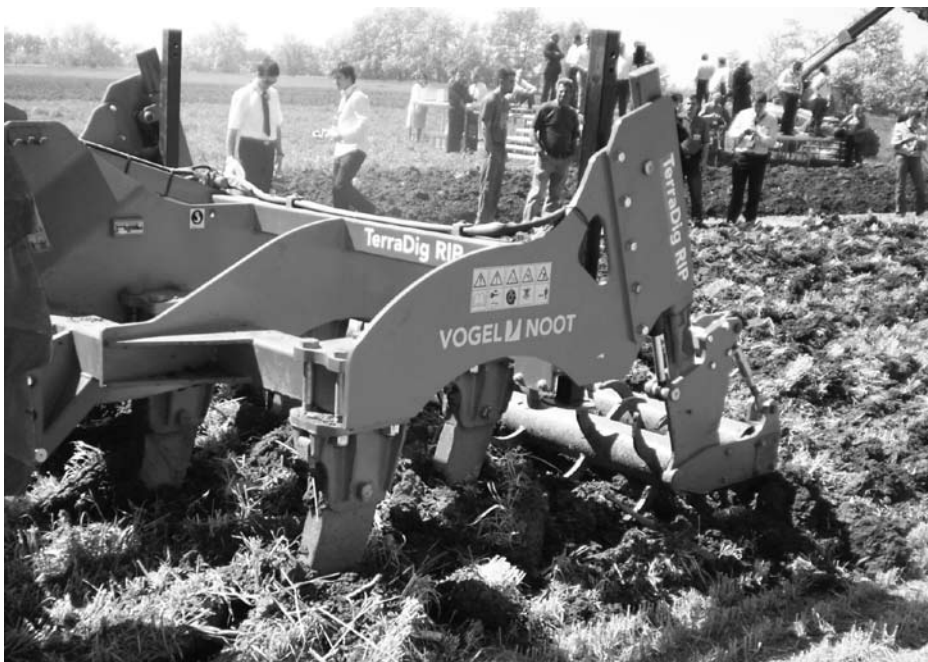
TerraDig obavlja izvrsne predradnje za daljnju obradu na posebno teškim, jako zgusnutim vrstama tla
