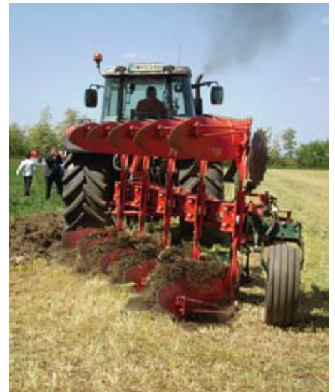
Zahvaljujući dodatnom obogaćivanju ugljikom, konstrukcijski i habajući dijelovi sada su daleko tvrdi i dugovječniji
