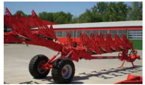
Plug s točkom ©plus Heros sadrži nove, jače konstrukcijske grupe i time je u izvedbi s 12 raonika izgrađen za traktore do 400 KS
