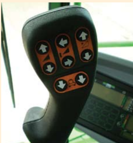
COMMANDERSTICK višefunkcijska ručica za upravljanje
