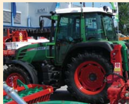
Fendt 312 vario kombinira nisku težinu i kompaktne omjere u području oko 100 KS s prednošću na jednostupanjski mjenjač
