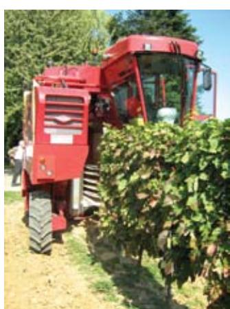
Konstantna vibracija osigurava snažnu trešnju ali ipak čuva bilje i omogućuju jednu veoma nisku frekvenciju trešnje od 380 do 420 udaraca / min
