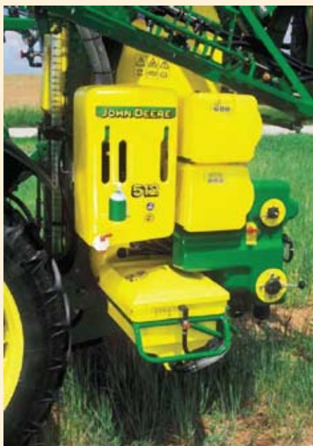
Prskalica je opremljena kutijom za smještaj pesticida, rezervoarom za čistu vodu i kutijom za smještaj zaštitne opreme
