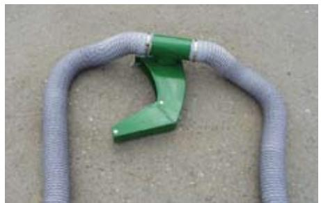
Završetak gibljivog crijeva, koje odvodi struju zraka iz ventilatora, nalazi na 10-ak cm od površine zemlje
