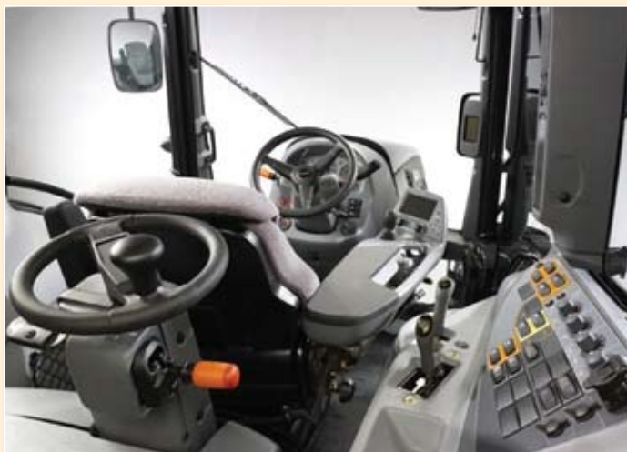
TwinTrac kontrole sustava za rad unazad je moguće naručiti i sa Versu, Direct i modelima S serije. Valtra je jedini svjetski proizvođač traktora koji na proizvodnoj traci (a ne naknadno) ugrađuje TwinTrac sustav za rad unazad.
