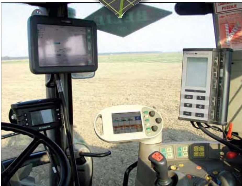
GPS u Fendt traktoru na Belju ugrađen za upravljanje s Hardy prskalicom
