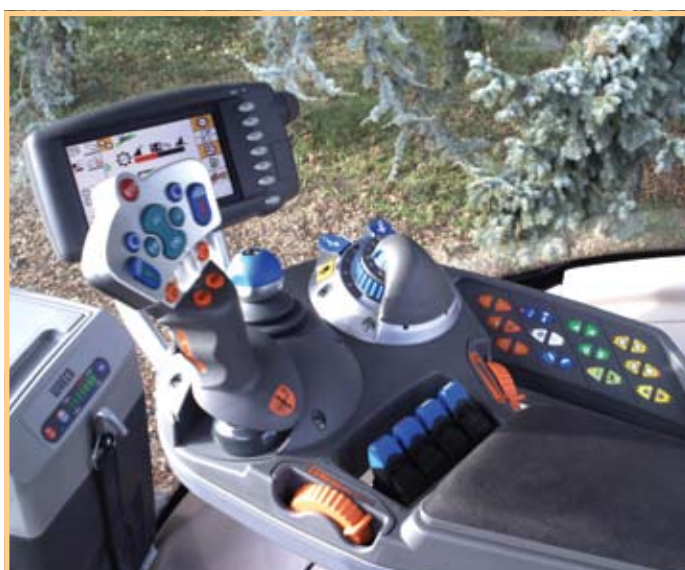
Za zahtjevne operacije Fendt nudi mogućnost da vozač okrene integriranu konzolu gdje se sve funkcije i ekrani pomiču zajedno sa sjedalom za 180°
