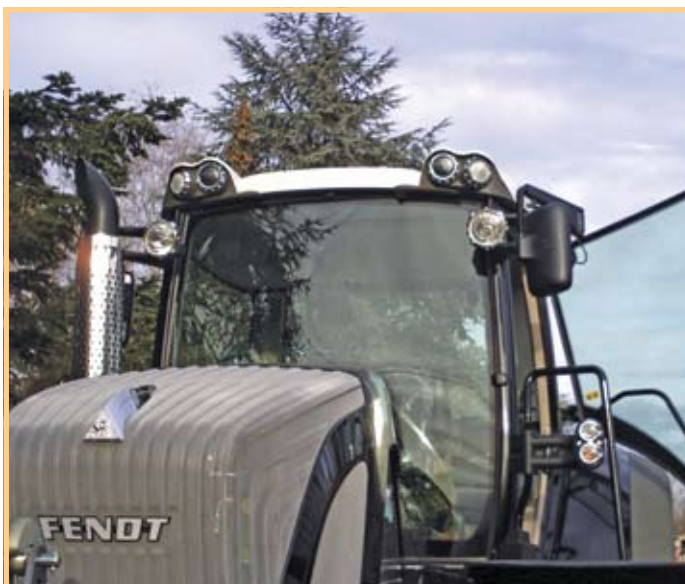
Moderna kabina X5 ima 5.5 m2 stakla što omogućava 320° horizontalne i 145° vertikalne vidljivosti
