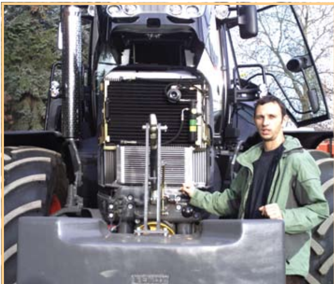
Traktor pokreće 360 KS snažan šesterocilindrični dizelski motor od 7142 kubika
