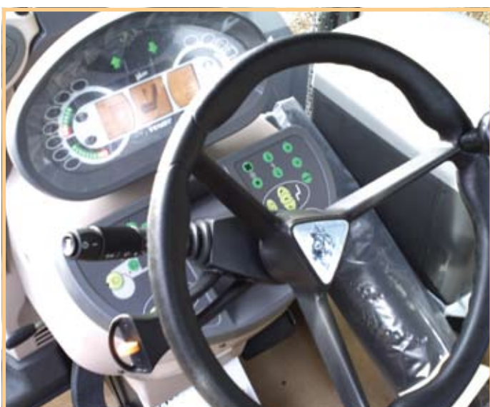
Digitalni pokazivač potrošnje goriva omogućuje pristup podacima o trenutnoj potrošnji goriva, potrošnji goriva po hektaru ili za određeni dio polja
