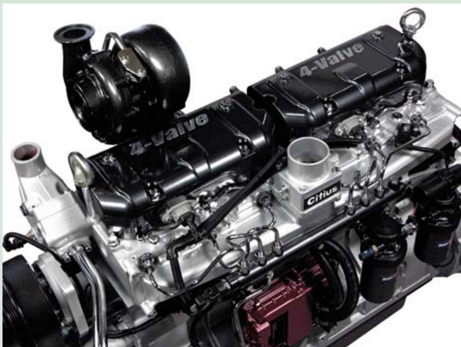
Može se reći i da je prednost i što osnovna konstrukcija Sisu diesel motora omogućava dugačak vijek trajanja intercoolera, vlažne košuljice cilindra s centralnim poprečnim osloncem
