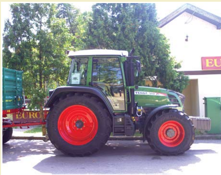
Vario mjenjači omogućavaju raspon brzina kretanja od 20 km/h do 50 km/h pri punoj snazi motora
