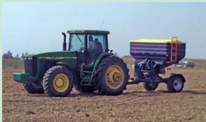
Električnom promjenom smjera okretanja diskova moguće je mijenjati sistem raspođjeljivanja gnojiva iz kabine traktora
