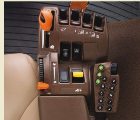
John Deere CommandARM konzola za AutoPowr traktore stavlja Vam kontrole najvažnijih funkcija traktora nadohvat prstiju.
