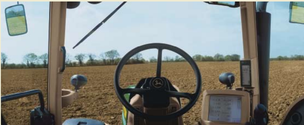
Glatki, uski profil poklopca motora pruža rukovatelju izvanrednu vidljivost sa njegovog sjedala.
