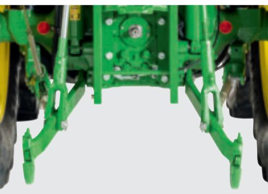
Priklučite sve što vam je potrebno za posao. Konstruiran za rukovanje i s najtežom priključnom opremom, izrazito robuna stražnja podizna poluga traktora 5M ima maksimalni kapacitet dizanja do 4.440 kg (maksimalni kapacitet dizanja na kukama).
