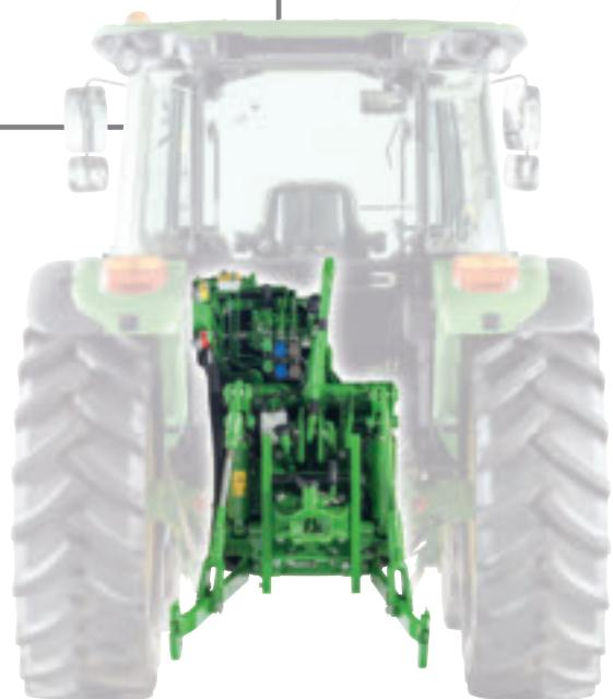
Opcionalna hidraulična kočnica prilikice s 2 voda omogućuje brzine transporta do 40 km/h s prikolicom opremljenom s novim hidrauličnim sustavom kočenja, poštivajući novu regulativu.
