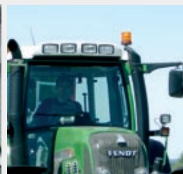
Zusatzbeleuchtung mit Xenon-Scheinwerfern; Rundumleuchte
