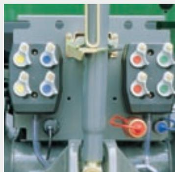
DUDK-Kupplungen; Externer Load-Sensing-Hydraulikanschluss
