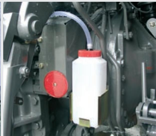
Der Austritt von Lecköl beim Kuppeln der Hydraulikanlüsse ist unvermeidbar. Beim 800 Vario läuft dies im Verkleidungskasten, der zugleich die Hydraulikkupplungen vor Schmutz schützt, zusammen und wird dann über einen Schlauch in einen gut zugänglichen Sammelbehälter geleitet.
