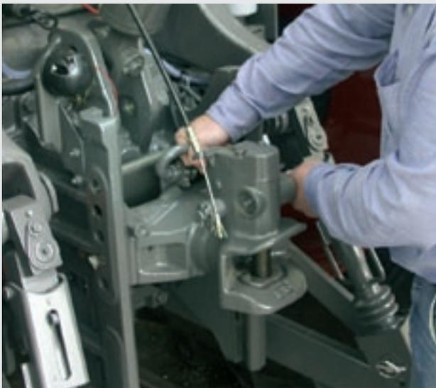
Das automatische Zugmaul mit Fernbedienung von Fendt ist bereits in der Serienausführung schnell und einfach in der Höhe verstellbar. Die Verriegelungsbolzen öffnen Sie über einen Hebel, an dem Sie das Zugmaul dann in den Führungsschienen nach oben ziehen oder ablassen – mit einer Hand.
