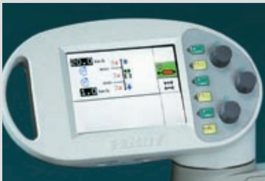
Die Bedienung und Anzeige der automatischen Lenkachssperrung für Anhänger mit Nachlaufachse, erfolgt über das übersichtliche und leicht zu bedienende Vario-Terminal. Über das Terminal wird die Auswahl des Steuerventils vorgenommen, die Lenkachssperrung aktiviert beziehungsweise deaktiviert sowie die obere und untere Einstellgeschwindigkeit entsprechend den vorhergehenden Bedingungen definiert.
