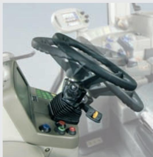
Fendt-Traktoren verfügen alle über eine automatische Blinkerrückstellung. Wie Sie es von Ihrem PKW gewohnt sind, wird der Blinker automatisch beim Zurücklenken wieder ausgeschaltet.
