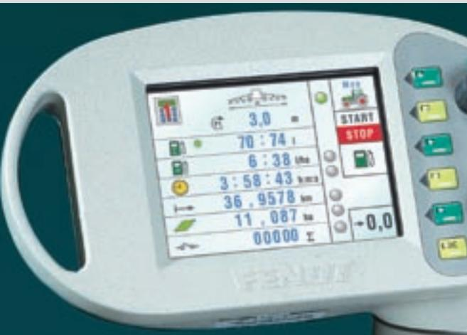
Im Varioterminale ist beim 800 Vario serienmäßig eine Kraftstoffverbrauchsanzeige integriert. Diese zeigt sowohl den aktuellen, als auch den Durchschnittskraftstoffverbrauch an und besitzt zwei Summenzähler. Im Bordrechner kann gleichzeitig der Kraftstoffverbrauch je Hektar erfasst werden.
