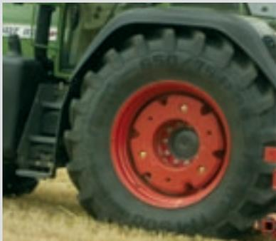
Für schwere Zugarbeiten stehen beim 800 Vario umfangreiche Ballastierungsmöglichkeiten zur Verfügung. Die Hinterachse kann mit bis zu vier Felgengewichten je 300 kg ballastiert werden.
