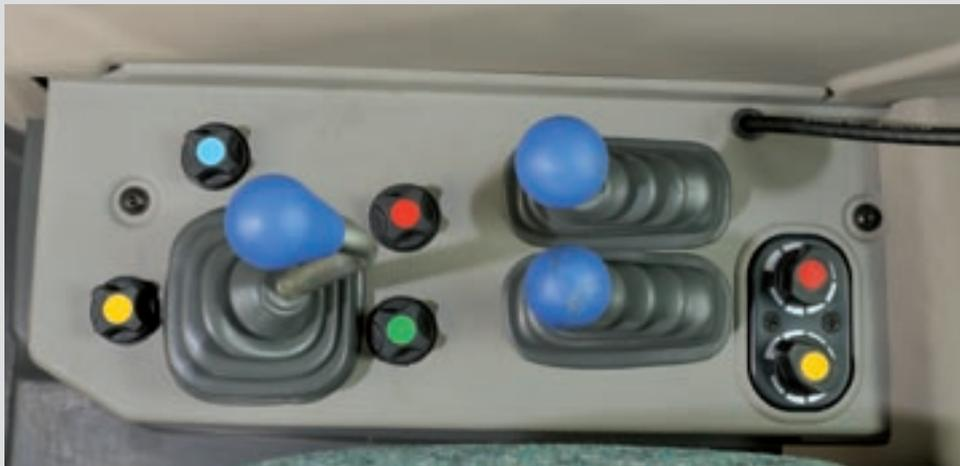
Mit dem Kreuzschalthebel können das 1. und 2. Ventil sehr feinfühlig bedient werden.
