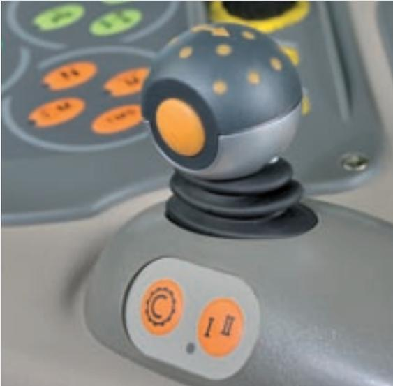
Hauptschalthebel, Gruppenschalthebel und Superkriechganghebel sind von nun an überflüssig. All das bedienen Sie ohne Umgreifen mit dem Variostick.
