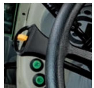
Mit dem Reversierhebel kann bequem mit der linken Hand die Fahrtrichtung gewechselt werden.
