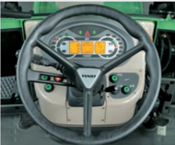
Das höhen- und neigungsverstellbare Lenkrad ermöglicht jedem Fahrer die ideale Sitzposition.
