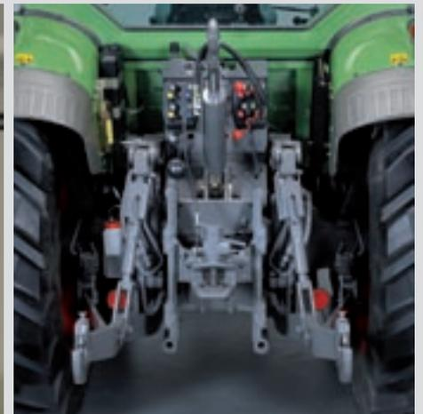
Übersichtliche Anordnung der Hydraulikanschlüsse und aufgeräumtes Kraftheber-Konzept.
