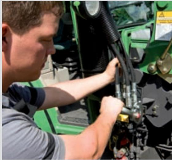
Der Multikuppler dient zum Anschließen aller hydraulischen und elektrischen Leitungen – frontladerseitig auch unter Druck. Damit ist der An- und Abbau der Frontlader in kürzester Zeit erledigt.
