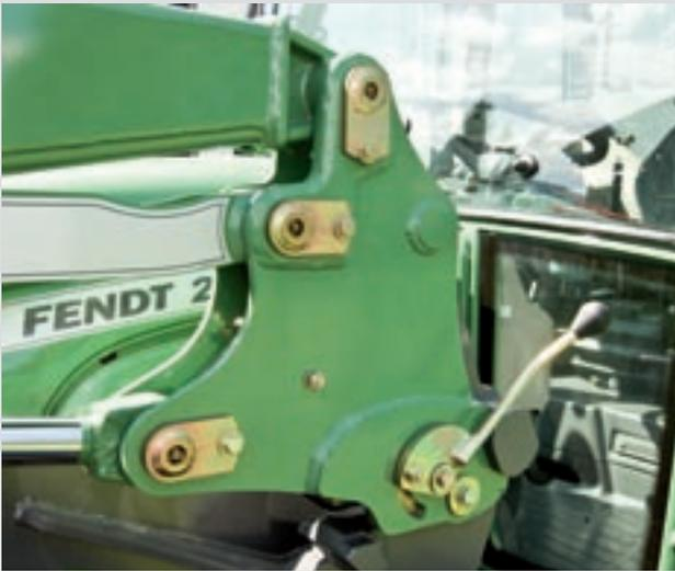
Mit dem Fendt CARGO-Lock bauen Sie den CARGO-Frontlader noch schneller und einfacher an Ihren 200 Vario an und ab. Die halbautomatische Verriegelung erspart Ihnen das oftmals schwergängige Einsetzen von Verriegelungsbolzen. Gleichzeitig bietet das System optimale Arbeitssicherheit, da der Frontlader sofort nach dem Einfahren verriegelt ist.
