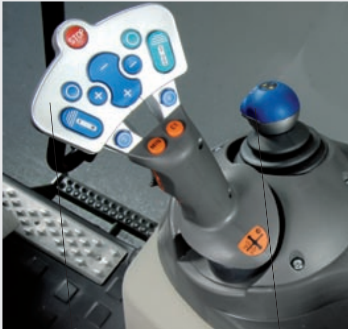
Multifunktionsjoystick, mit Bedientasten für Heckkraftheber, Steuerventile, 3. und 4. elektrischer Kreis, Tempomat- und Motordrehzahlspichertaste
