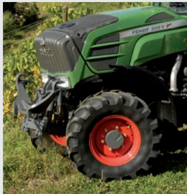
Der Unterlenker des Frontkrafthebers ist werkzeuglos hochklappbar.
