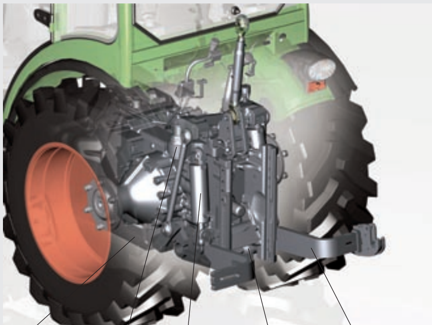
Kraftheberanlenkung am Kraftmessbolzen Zylinder zur Neigungsverstellung Hubzylinder Zylinder zur Seitenverstellung Unterlenker
